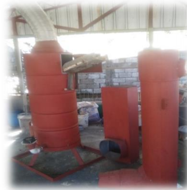
Equipos del Laboratorio de biomasa del IIBI, mostrando un gasificador de cascarilla de arroz
