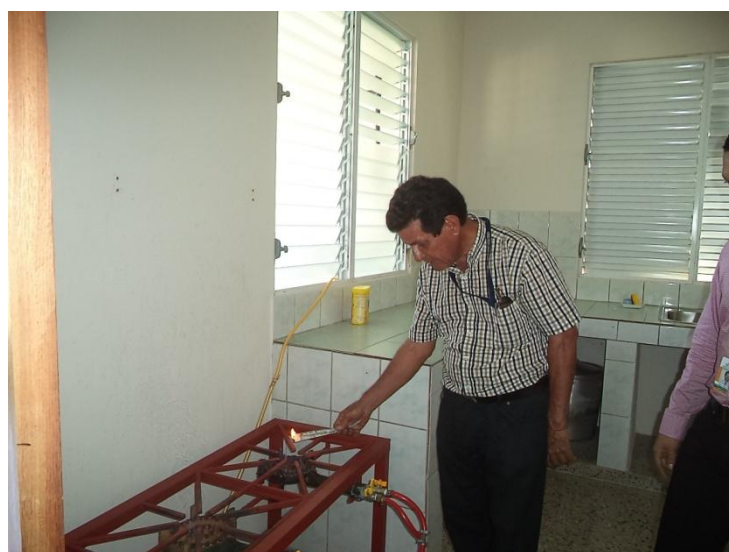
Foto2. Estufa de biogás modificada en el IIBI
