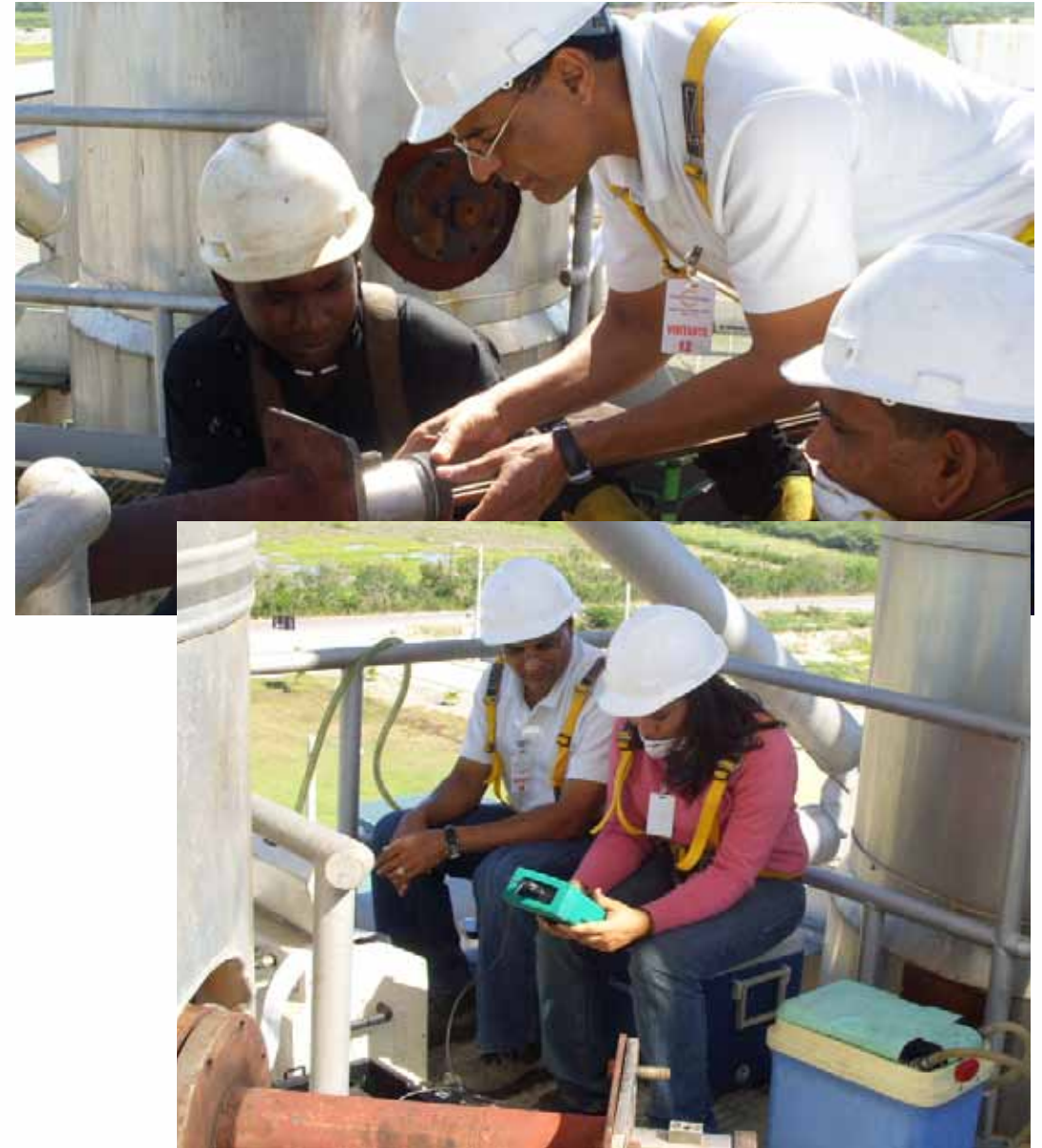
Técnicos realizando mediciones ambientales en chimeneas.
