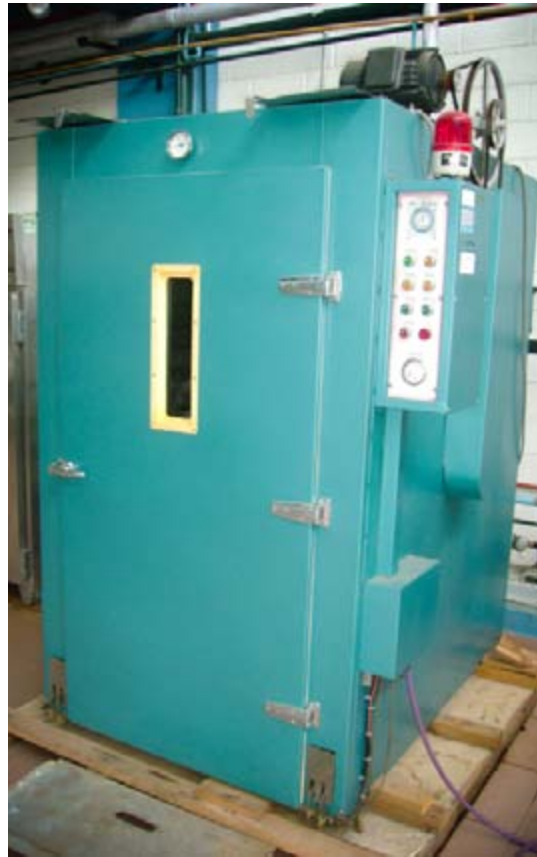
Copia de Deshidratador a gas propano.
